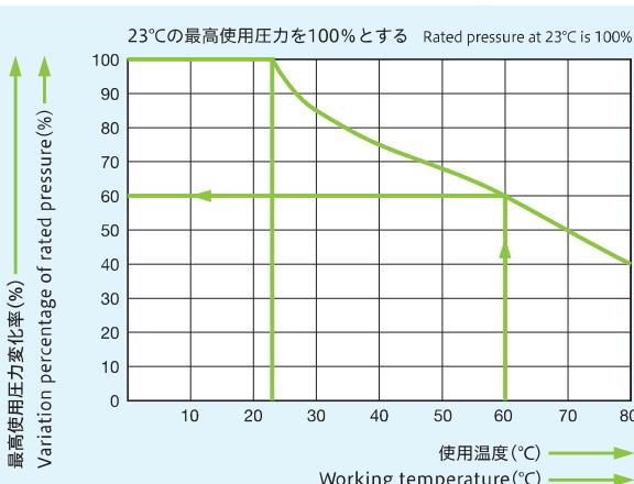
チューブの最高使用圧力は温度の上昇により下降してゆきます。(グラフ参照)
