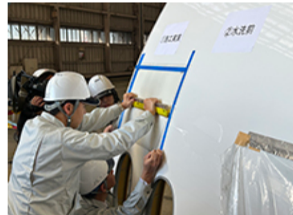
モックアップによる実演。 塗膜シートを機体に圧着している様子
